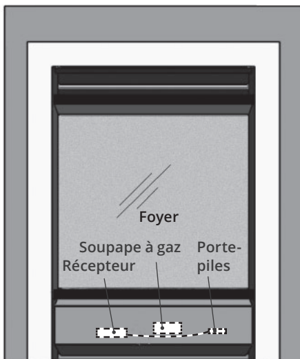
Porte-piles situé à côté de la soupape sous la boîte de foyer derrière le panneau d'accès.
